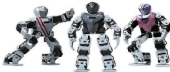
Figura 2 Robot Bioloid Premium ensamblado con forma humanoide.
