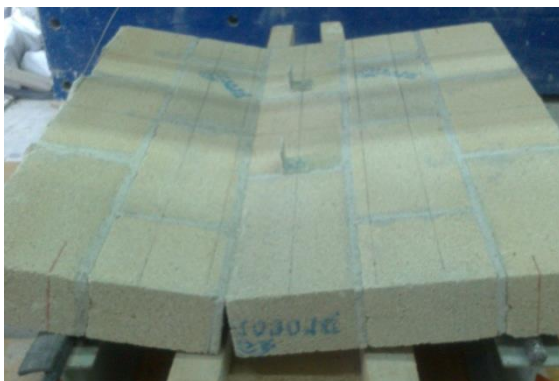
a) Falla por adherencia
