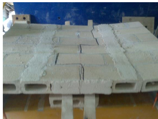
b) Falla combinada
