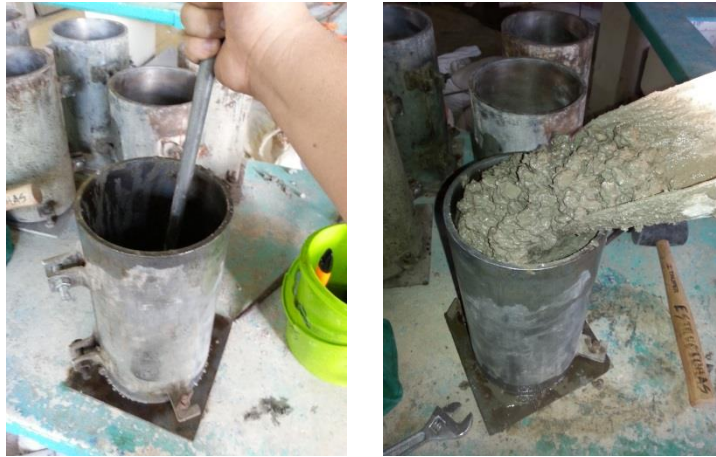
Figura 3.20 Toma de muestras de concreto
