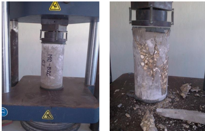
Figura 3.21 Ensayo de cilindros de concreto
