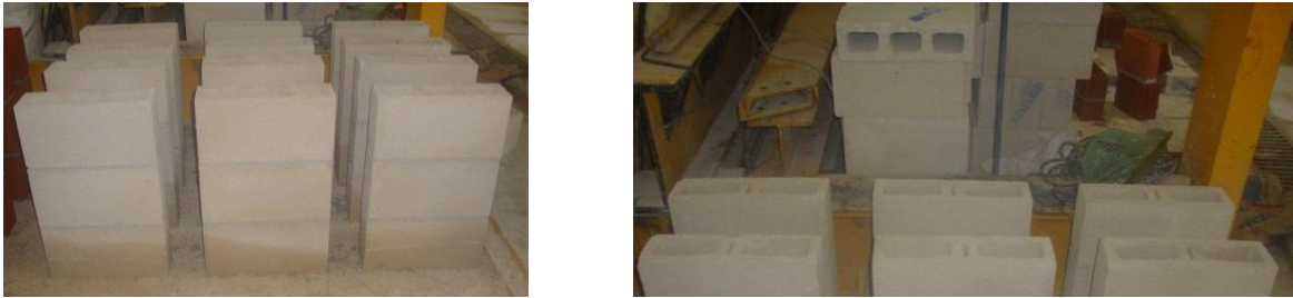
Figura 3.16 Pilas de mampostería de B2C
