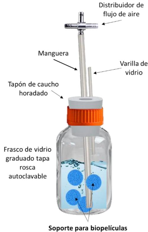
**Figura 14.** Representación esquemática del dispositivo para la aclimatación en HAPs de los consorcios natural y bacteriano formado.
